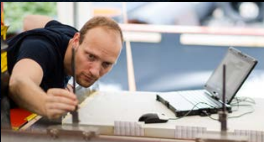
Talsperre Lehnmühle: Vier der elf Überlaufelder (Hintergrundfoto, oben) wurden auf Basis von Modellversuchen an der HTWK Leipzig (kleines Foto, mit Projektmitarbeiter Tilo Buschmann) so umgebaut, dass bei einem extremen Hochwasser mehr Wasser abgeleitet werden kann.
