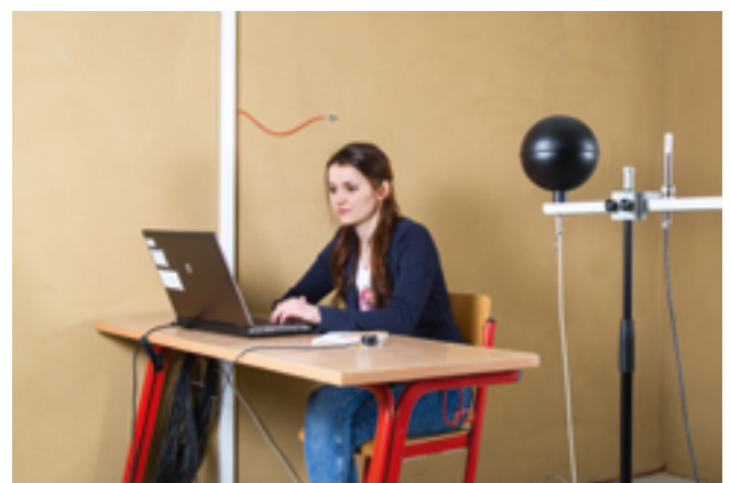
Lena Voelker kontrolliert im Holz-Modul, welche Daten der Sensor für die empfundene Temperatur (rechts) ausliefert.
