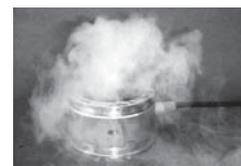
Durch Ultraschall können Flüssigkeiten zerstäubt werden, so dass künstlicher Nebel entsteht
