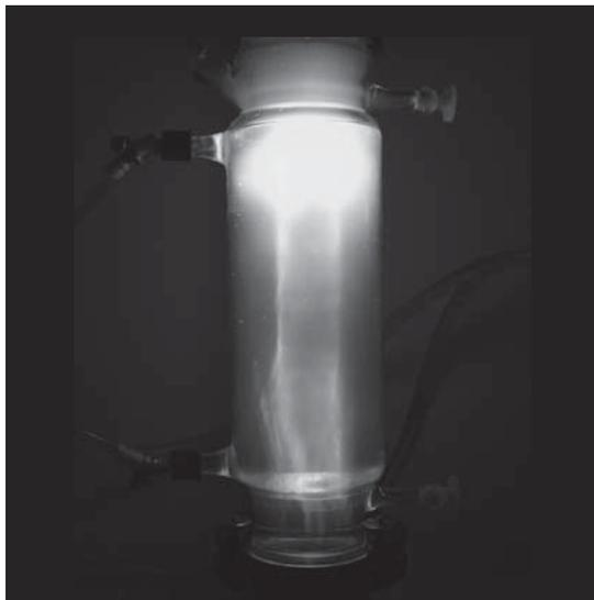
Weil Ultraschall normalerweise weder sicht- noch hörbar ist, kann er mit Hilfe von Sonolumineszenz sichtbar gemacht werden.
