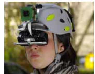
Noch als Rohfassung: Funktionsmuster der tragbaren Sehhilfe für Tests mit Probanden
