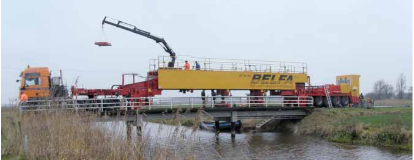
Das Belastungsfahrzeug BELFA im Einsatz an einer Brücke in Wittmund – das BELFA wurde seit den 1990er Jahren an der HTWK Leipzig mitentwickelt
