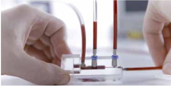
Damit Chirurgen an „blutenden“ Simulationsmodellen üben können: Überprüfen der Anschlüsse für ein künstliches Kreislaufsystem
