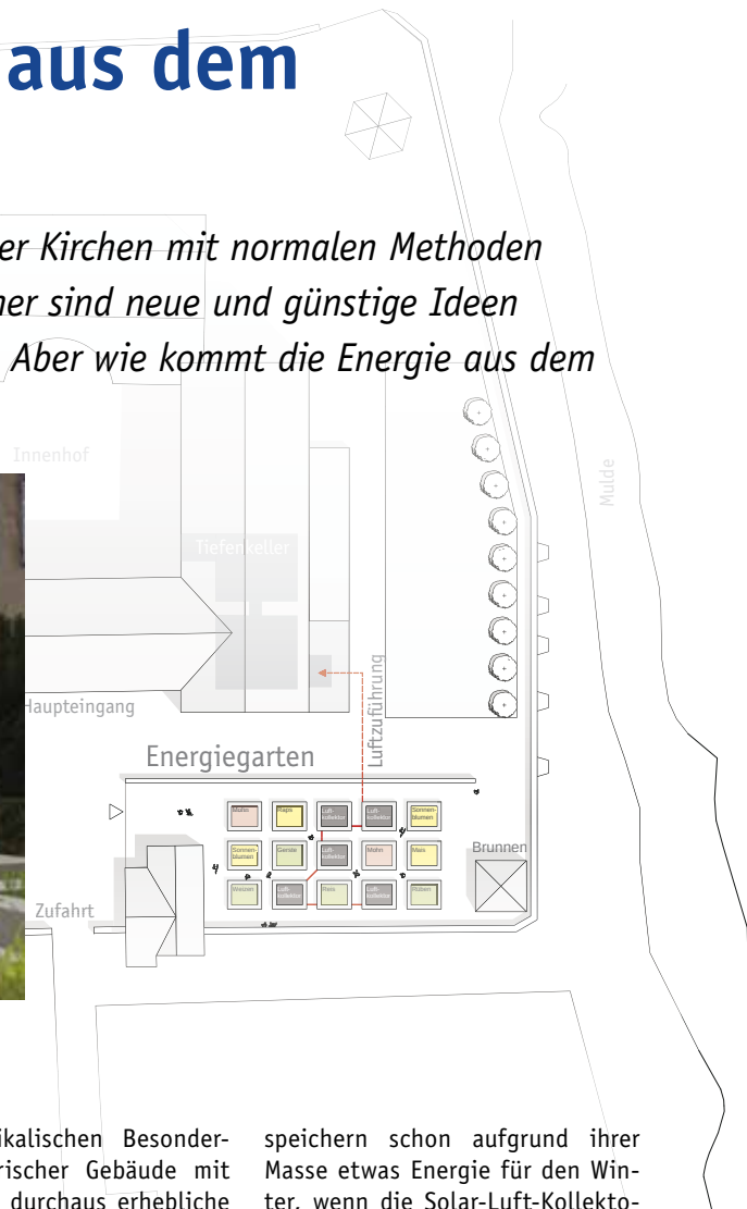
Ein Solar-Luft-System zur Erwärmung von Gebäuden mit extrem großer Speichermasse entwickelten Wissenschaftler der HTWK Leipzig für das Schloss Trebsen
