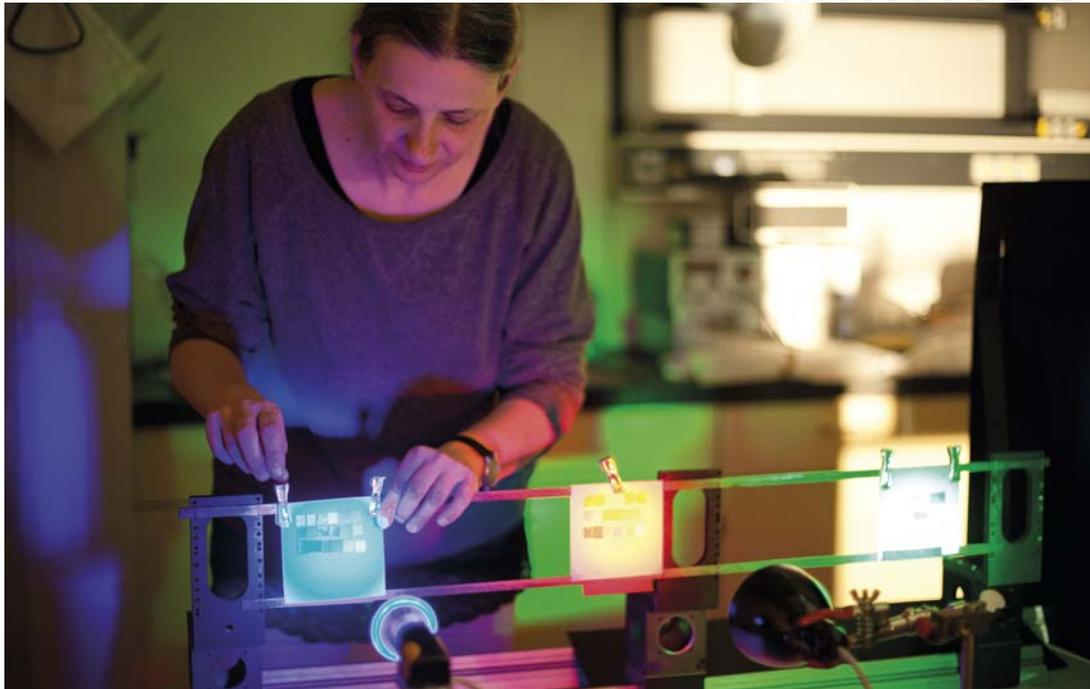
Eine Frage der Wellenlänge: Bereits seit Ende 2011 läuft zu dem geplanten Projekt ein erster Langzeitversuch, bei dem mehrere Farbproben mit unterschiedlichen Lichtquellen bestrahlt werden
