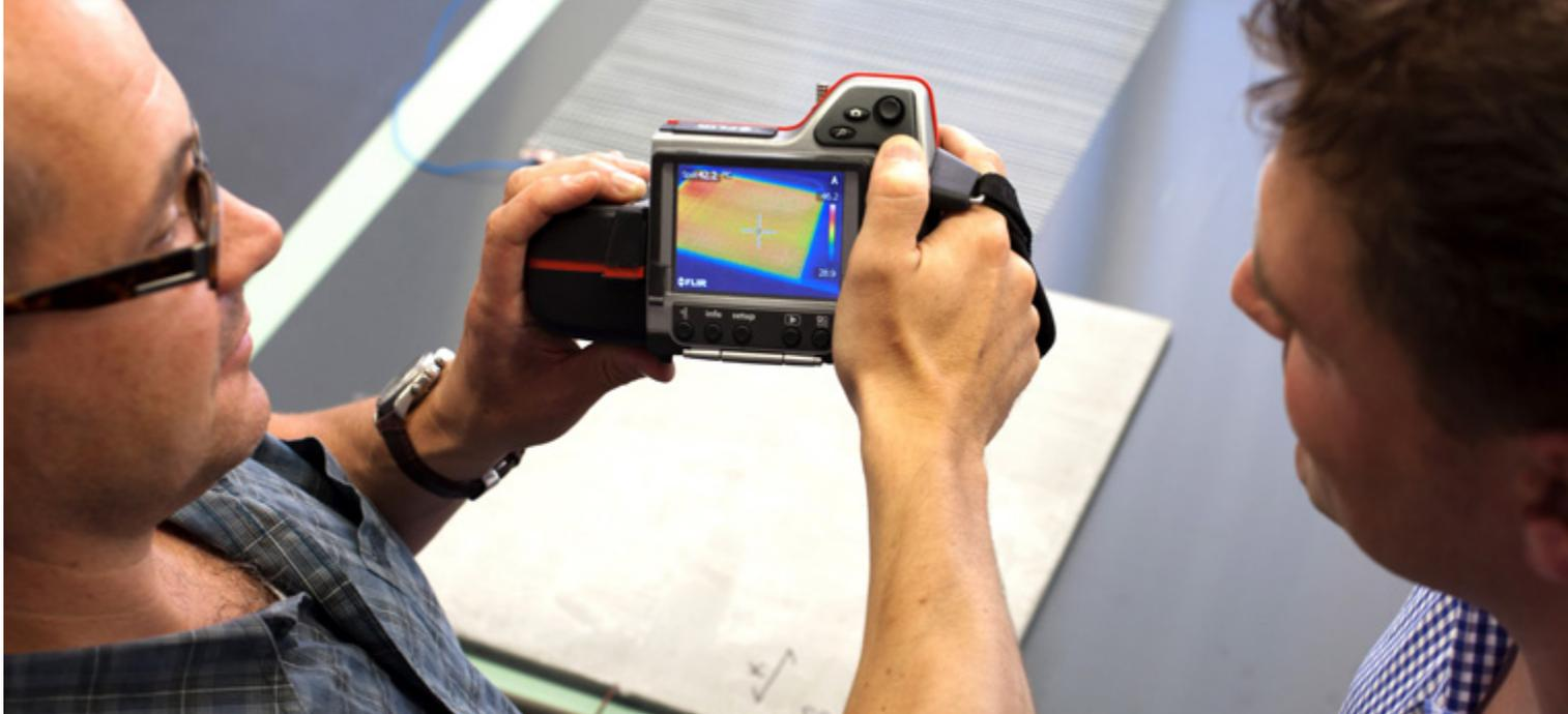
Das textile Gelege in Textilbeton kann in Zukunft als Heizung verwendet werden - hier bei einer Testaufnahme mit Wärmebildkamera im Labor der Qpoint Composite/Dresden
