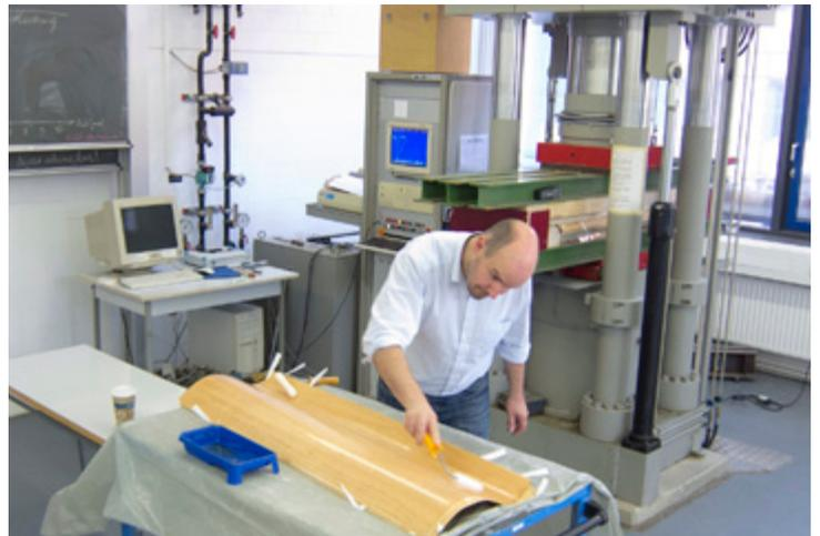
Projektmitarbeiter Lars Ehlers bei der Herstellung eines Prototyps aus verformtem Schichtholz
