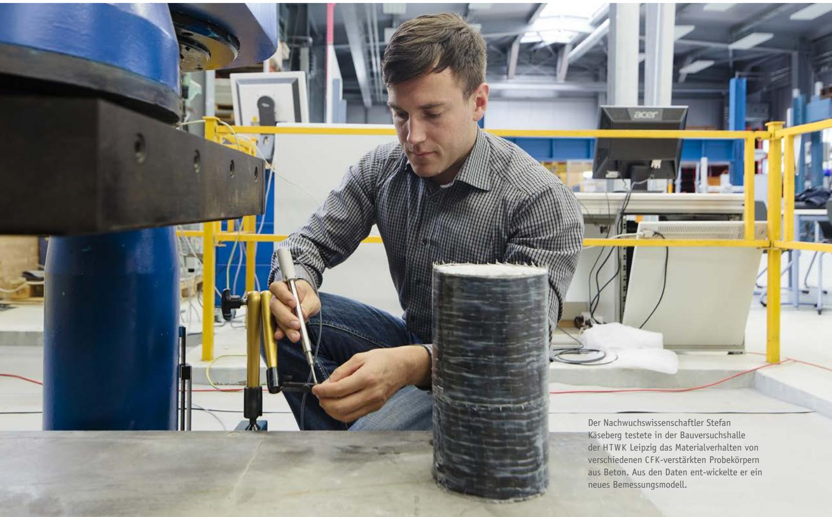
Der Nachwuchswissenschaftler Stefan Käseberg testete in der Bauversuchshalle der HTWK Leipzig das Materialverhalten von verschiedenen CFK-verstärkten Probekörpern aus Beton. Aus den Daten entwickelte er ein neues Bemessungsmodell.
