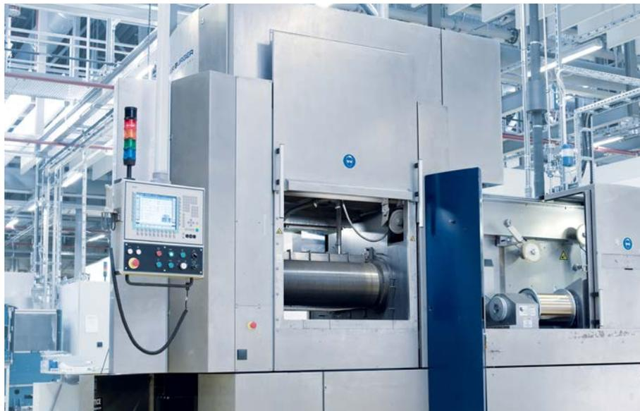
Mit einer Drahtsäge werden die Solarzellen aus Silizium-Blöcken ausgeschnitten. Die hier abgebildete Drahtsäge befindet sich am Fraunhofer-Center für Silizium-Photovoltaik in Halle, wo HTWK-Stiftungsprofessor Jens Schneider die Nachwuchsforscherguppe MechSi leitet.
