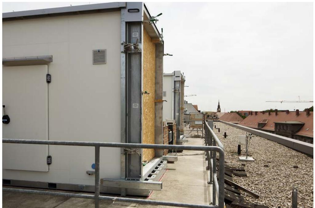
In die Westfassade der Prüfkabine können ab sofort verschiedene Fassadenkonstruktionen zur Validierung unter realen Witterungsbedingungen eingesetzt werden.
