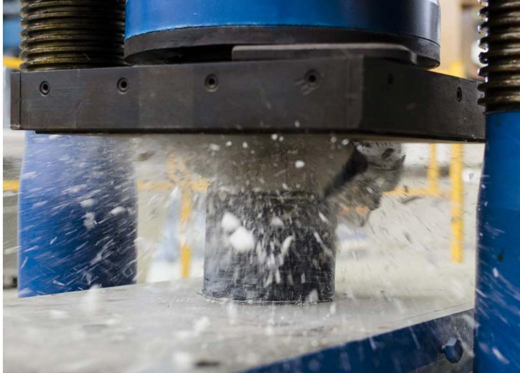
Wenn eine CFK-verstärkte Betonstütze überlastet wird, explodiert diese förmlich. Bei echten Bauwerken darf das nicht passieren. In der Bauversuchshalle gehört das aber zum Versuchsablauf.
