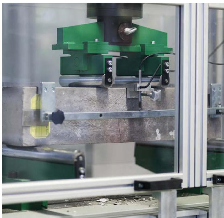
In der Biegeprüfmaschine wird der Beton auf seine Belastbarkeit untersucht.
