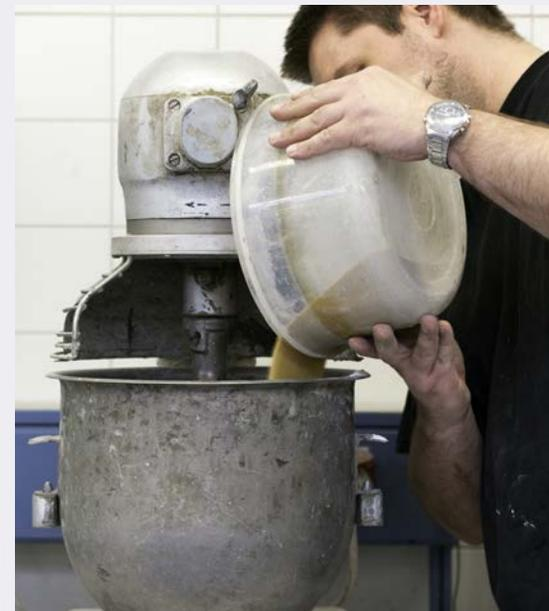
Die neuen Betonrezepturen werden im HTWK-Labor in kleinen Mengen gemischt, betoniert und dann getestet.
