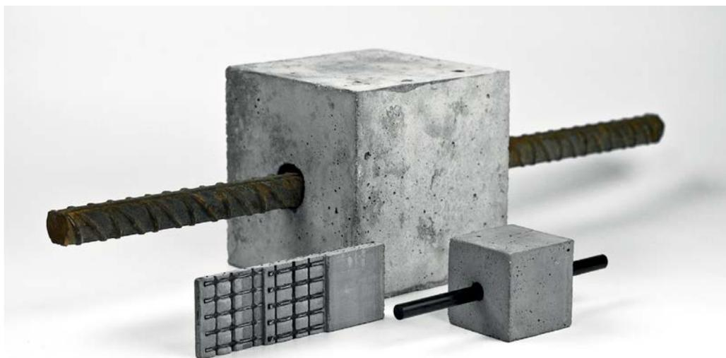
Um den Stahl im Beton vor Korrosion zu schützen, ist eine dicke Betonschicht erforderlich (großer Würfel links). Bauelemente aus Carbonbeton (Würfel und Platte rechts im Bild) sind deutlich schmäler und verbrauchen weniger Material.
