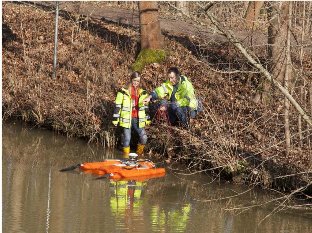
Die HTWK Leipzig unterstützt das Projekt „Lebendige Luppe“ mit hydraulischen und geotechnischen Analysen. Im Bild: Die Wasserbauexperten Tilo Sahlbach und Barbara Krahl messen den Wasserdurchfluss in der Pleiße.
