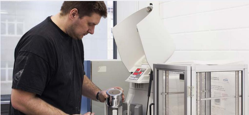
Ein besonderes Augenmerk der Forschung an der HTWK Leipzig liegt auf der Recyclingfähigkeit der neuen Betonrezepturen: Nachdem die Carbonfasern aus dem alten Beton entfernt wurden, wird dieser zermahlen. Das Pulver soll als Gesteinskörnung wiederverwendbar sein. Im Bild: Projektmitarbeiter Emanuel Lägél mit einer Probe Recycling-Beton an einer Gesteinsmühle.
