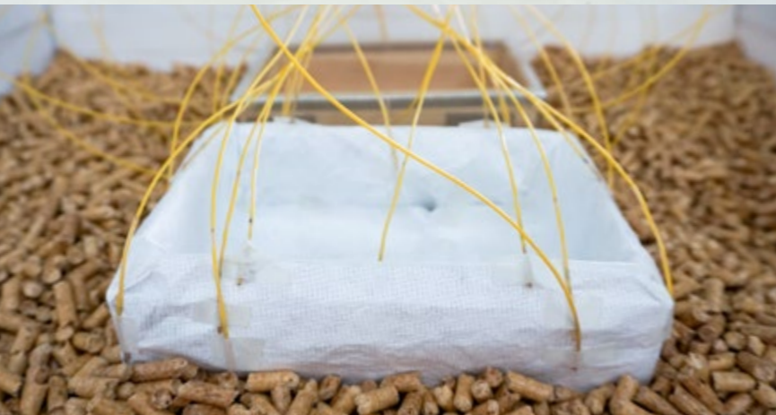
Das kolumbianische Kästchen wurde für den Test des Radiowellen-Verfahrens in Vlies eingewickelt, mit Temperatursensoren (gelb) bestückt und in eine Kiste aus Holzpellets gebettet.
