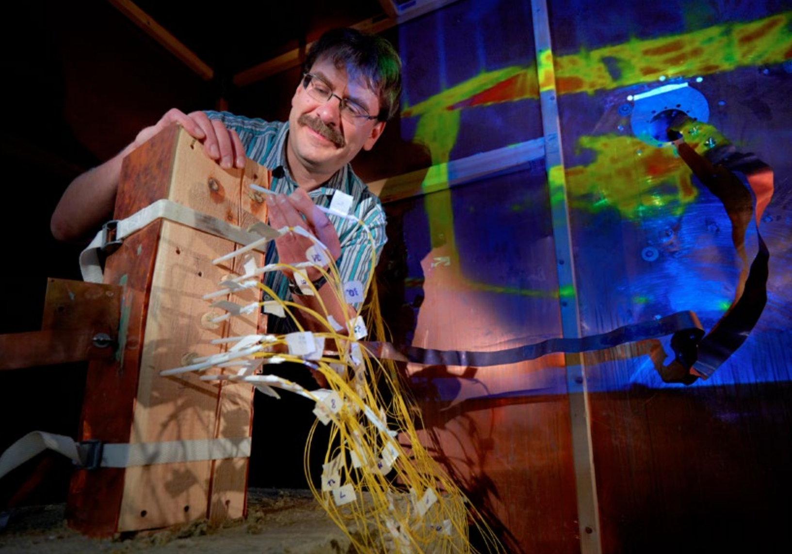
Dr. Ulf Roland in der Radiowellen-Versuchskammer. Über die Kupferplatten wird im Holzbalken ein elektromagnetisches Feld erzeugt, das diesen von innen heraus erhitzt. Faseroptische Sensoren (gelb) messen die Erwärmung.
