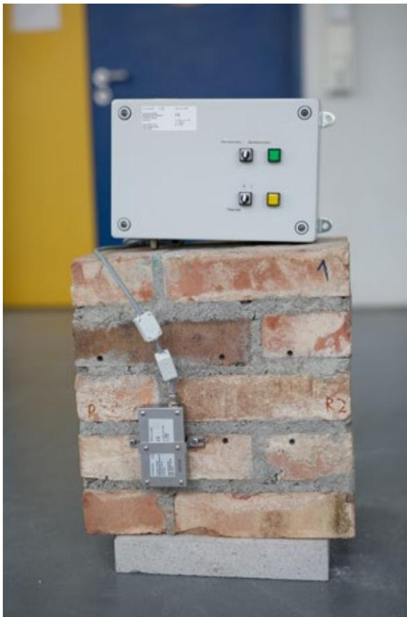
Die kleine Box an der Mauer – die Messeinheit – registriert Raumtemperatur, Mauer- und Luftfeuchtigkeit. Die große Box – die Steuereinheit – empfängt von mehreren Messeinheiten diese Daten, wertet sie aus und sendet sie weiter an einen Computer
