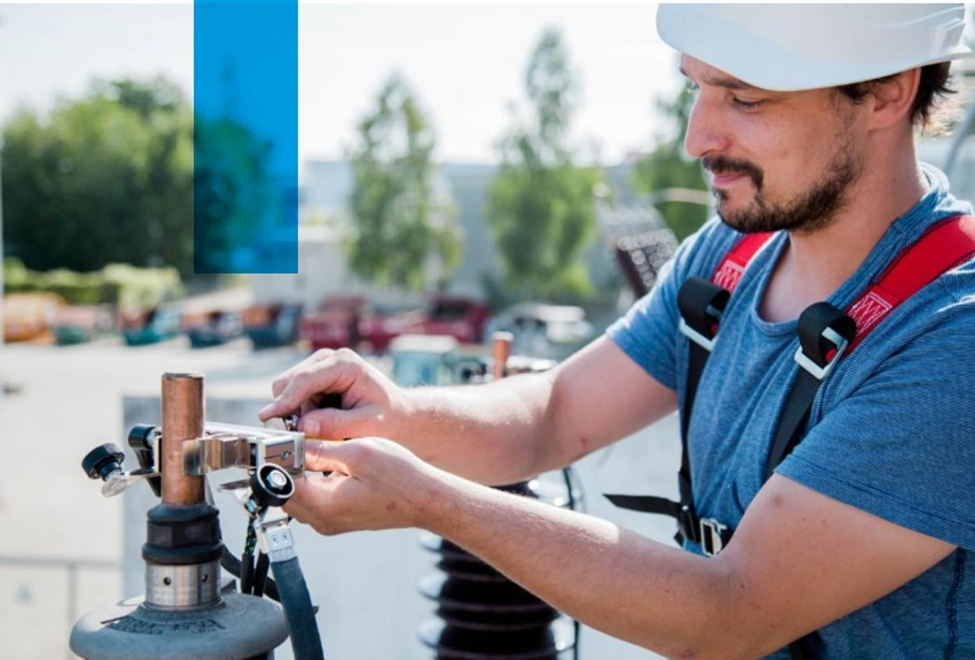
Peter Kästel ist auf den Trafo geklettert, um dort das Messsystem für die Frequenzganganalyse anzuschließen
