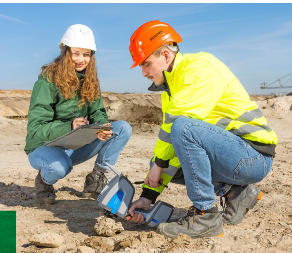
Vanessa Fock und Bénédicte Löwe im Tagebau Profen bei der Bodenanalyse mittels Handscanner
