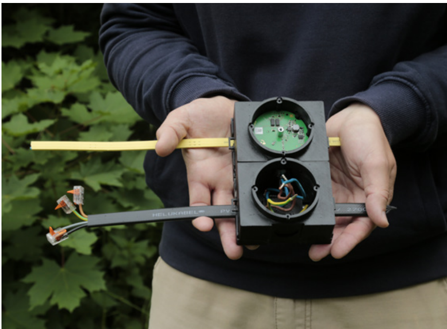
Diese schaltbare Steckdose im neu entwickelten Gehäuse verbindet ein AS-Interface-Kabel (oben) und eine 230-Volt-Zuleitung (unten) für eine automatisierte Kabeleinbringung und -kontaktierung in Carbonbeton-Wänden
