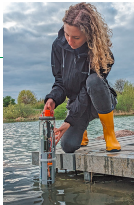
Stefanie Penzel mit einer mobilen Tauchsonde zur Überwachung der Wasserqualität
