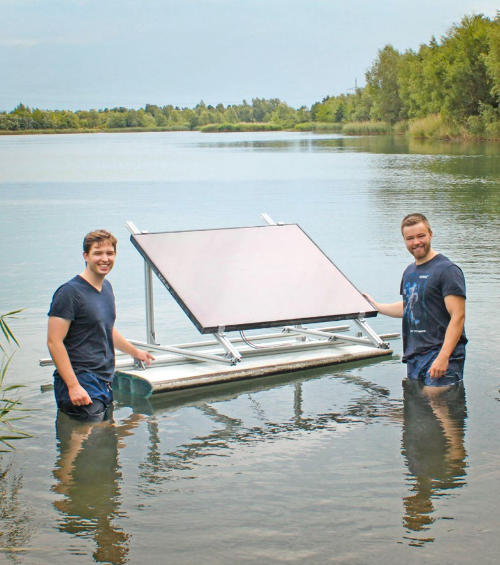
Kevin Strödter (l.) und Philipp Johst am Solarmodul mit umfunktioniertem Rotorblatt-Schwimmsegment
