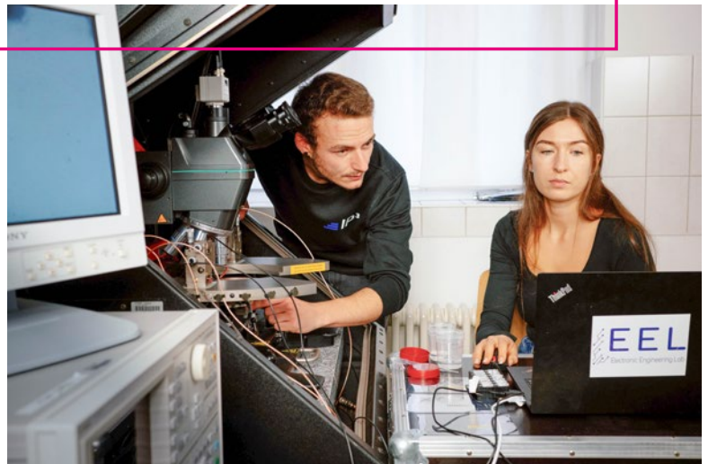
Florian Muschka und Anika Mühl drucken organisch elektrochemische Transistoren
