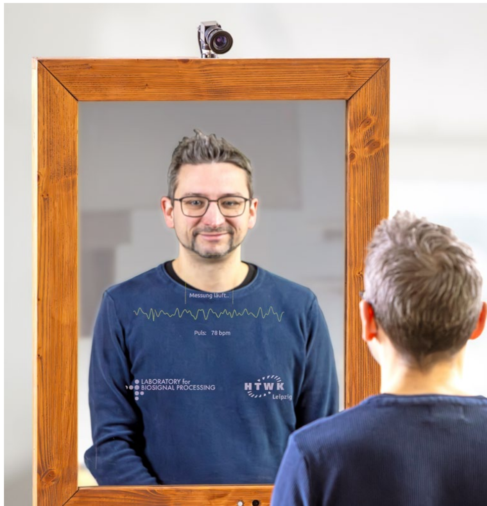
Sieht mehr als nur das Gesicht: Der „magische“ Spiegel des LaBP, der aus Kameradaten Vitalparameter abliest
