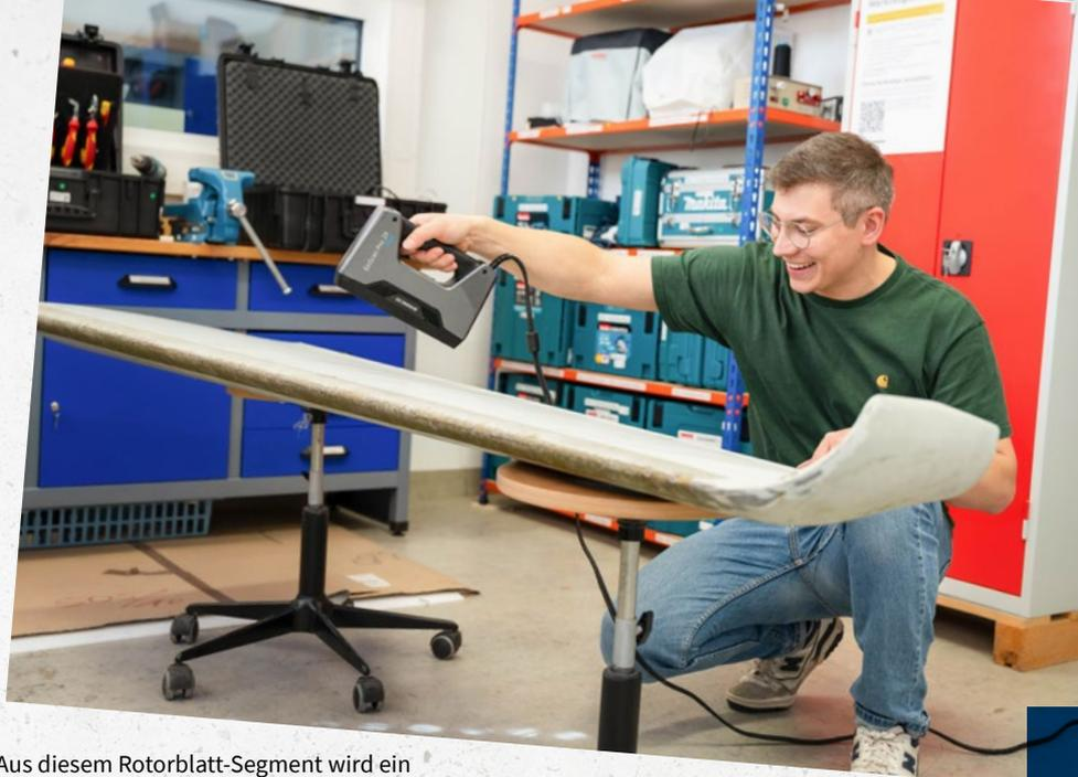
Aus diesem Rotorblatt-Segment wird ein Tisch. Dimitrij Seibert scannt das Werkstück zunächst mit dem 3D-Scanner, um die weiteren Schritte digital zu planen
