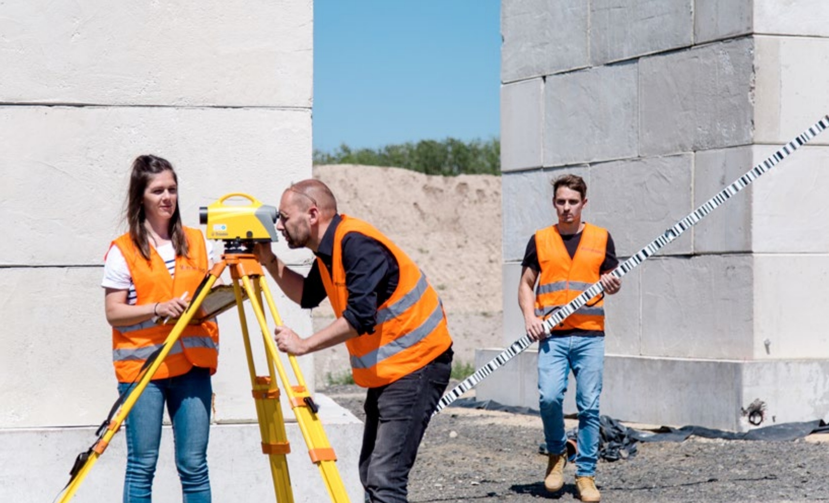
Fünf Monate lang führen die Wissenschaftler der G 2 Gruppe Geotechnik regelmäßig zum Versuchsgelände an der A 72, um die Verformungen des Belastungsstandes auf dem Braunkohle-Kippengelände zu kontrollieren.
