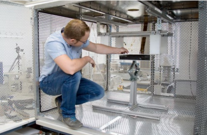
Martin Arlt zeigt den Versuchsaufbau der mobilen Radiowellen-Anlage im HTWK-Straßenbaulabor.
