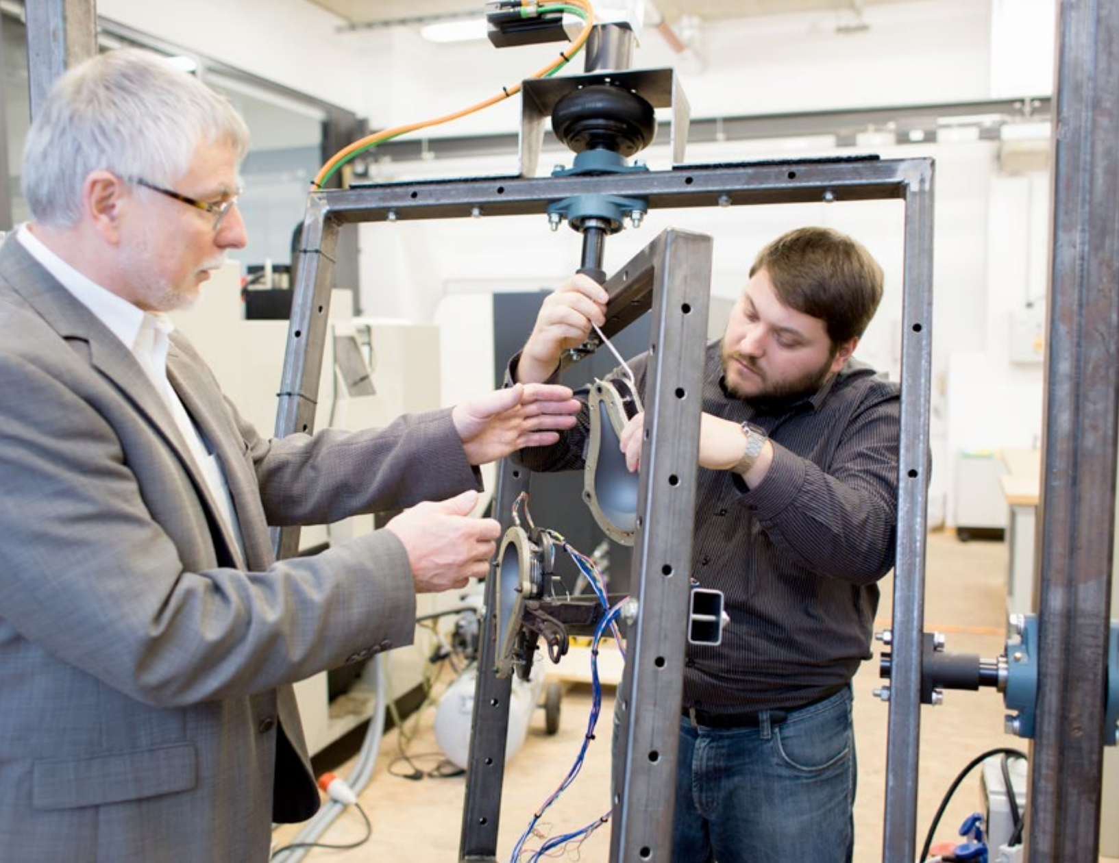
Prof. Fritz Peter Schulze (links) und Projektmitarbeiter Hans-Martin Dörfler am Prototyp der Rotationsgussmaschine. Die beiden Metallrahmen können sich frei um verschiedene Achsen drehen und gewährleisten so die gleichmäßige Benetzung der Form.
