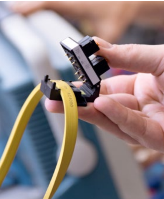
Einfacher Anschluss: Die Kabel für AS-Interface werden per Hand zusammengeklippt.
